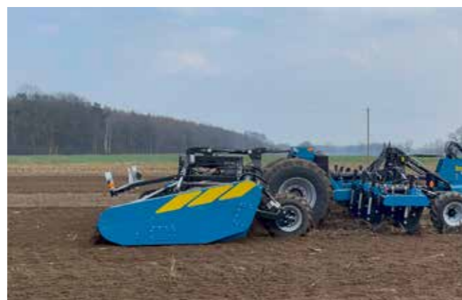
▲ Werktuigendrager met opklapbare woelerbalk 600cm werkbreedte. Afgebeeld met 38FSX spitmachine. Transportbreedte: 300 cm (opgeklapt).
