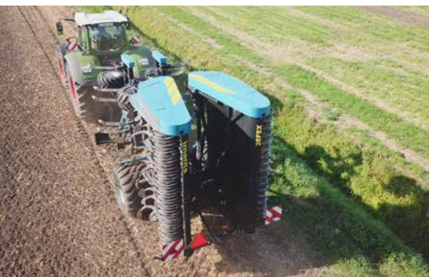
▲ Werktuigendrager met opklapbare woelbalk en spitmachine 600 cm werkbreedte. Afgebeeld met 38FSX spitmachine, opgeklapt in transport stand 300 cm breed.
