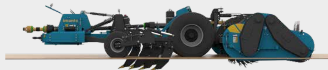
Als afbeelding is gekozen voor de 58SX450PLH met 8 woelpoten. Werkdiepte van de woelpoten is (afhankelijk van de omstandigheden) tot 50 cm diep. De spitassen en harkrol werken van 15 tot 35 cm diep.
