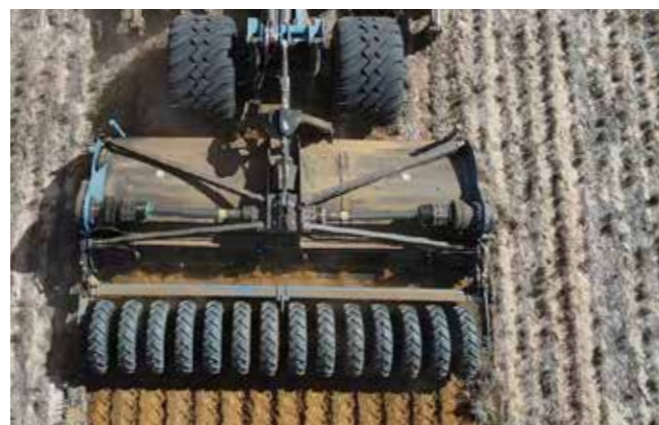
▲ Werktuigendrager met starre woelerbalk 450 cm breed. Afgebeeld met 58SX spitmachine met bandenpakker.
