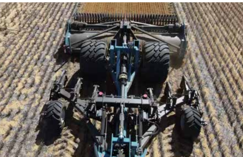
▲ Werktuigendrager met starre woelbalk 450 cm breed. Afgebeeld met 58SX spitmachine met dakringrol.
