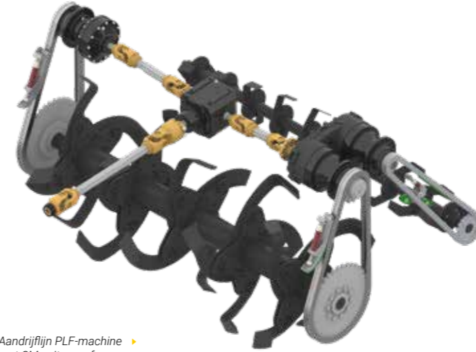
Aandrijflijn PLF-machine met SM spitassen en freesas
