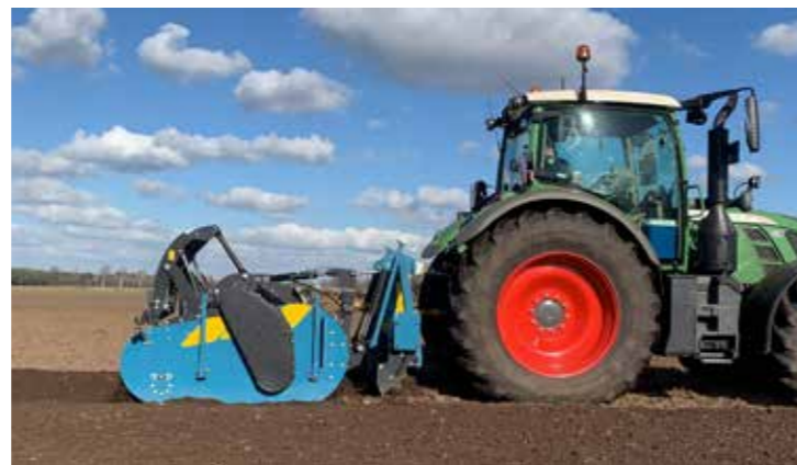
▲ Culter in combinatie met spitmachine.
