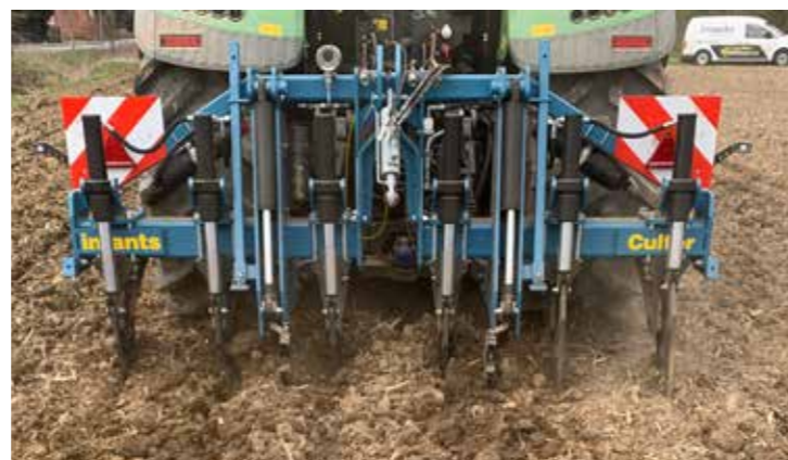
▲ Culter in HDS-uitvoering met hydraulische stenenbeveiliging
