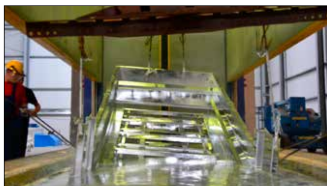
Thermisch verzinkingsbad (galvanisatie aan binnen- en buitenzijde)
