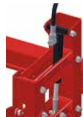
Hydraulische drukinstelling door middel van dubbelwerkende stuurinrichting
