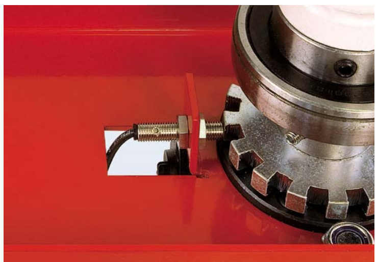
Contactloze sensor voor het opvragen van het toerental, ongevoelig en slijtvast
