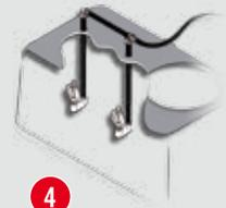
**IT** Indicatore livello cisterna con scala graduata a secco visibile anche dal posto di guida (●)
