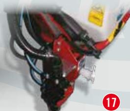
**IT** Sospensione pneumatica (●). Isola la barra dalla maggior parte delle vibrazioni trasmesse dalle ruote della macchina in fase di lavoro. L'utilizzatore ha possibilità di regolare la pressione di lavoro in base alle condizioni del terreno
