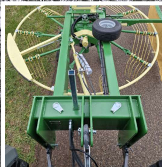
HYDRAULISCH ZWENKBAAR PARALLELFRAAME (TOT 1,50M)
