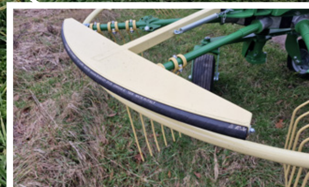
BOOMSCHORSBESCHERMER, ZWENKBAAR I.C.M. OVERLAST-BEVEILIGING OP ZWENKCILINDER
