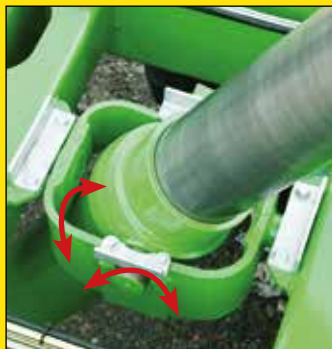
Dubbel schommelframe waarin de cilinder geplaatst wordt
