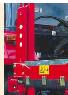
Solide loopwagens met speciale pasbouten vangen de reactiekrachten van het snijraam spelingsvrij en moeiteloos op.
