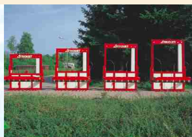
Keuze uit 4 typen machines, variërend van 115 cm t/m 195 cm. kuilvoerblokhoogte.
