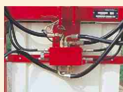
Het betrouwbare stuurregelblok laat het gepatenteerde snijproces volkomen synchroon verlopen.
