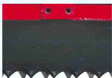
De vasthoudtanden houden niet alleen vast, maar beschermen bovendien de snijmesses tegen stenen en dergelijke. Ze steken n.l. onder het mes uit.
