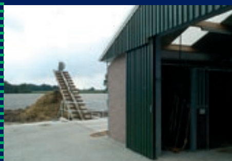
Rondgaande-ketting Uitmeststelsysteem met vaste opvoergoot.
